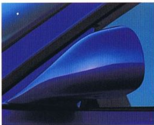
Strömungsoptimierter und beheizter Außenspiegel, serienmäßig für BMW M3.
